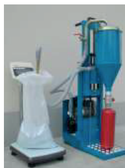
PLNĚNÍ PŘENOSNÉHO HASICÍHO PŘÍSTROJE POMOCÍ VÁHY ETW100
