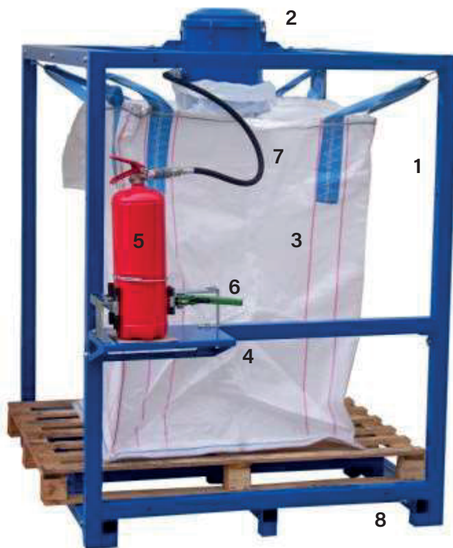
Vyprazdňování přenosného hasicího přístroje
